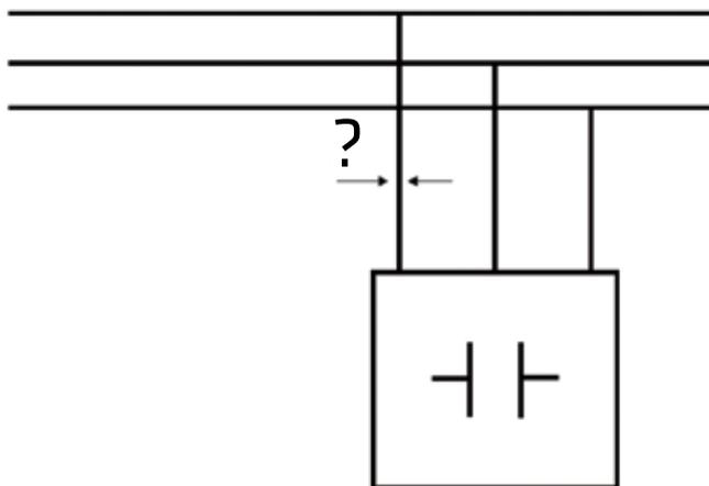
A diferencia de la gran mayoría de aparatos eléctricos los condensadores de compensación de Energía Reactiva, ER, una vez que están conectados a una red de alimentación de nivel de tensión eficaz apreciablemente constante, funcionan a plena carga de forma permanente.
