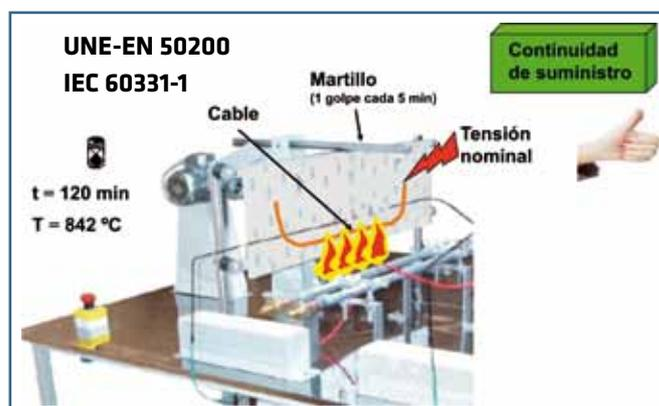
La resistencia al fuego trata de poner de manifiesto la aptitud del cable para dar servicio en condiciones extremas de un incendio. Los cables resistentes al fuego están destinados a aquellos servicios que se pretende no dejen de funcionar en un eventual siniestro con fuego (servicios de seguridad, servicios indispensables...).
