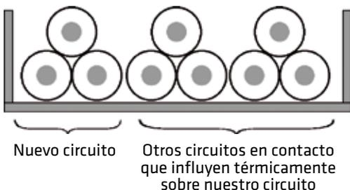
En la tabla de intensidades admisibles vemos que este cable soporta 271 A, que afectado del coeficiente de corrección por agrupamiento 0,80 nos queda en una intensidad máxima de...
