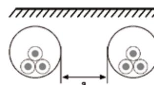
Consideramos suficiente seguridad utilizar éstos valores para circuitos con cables unipolares enterrados bajo tubo o conducto (la norma omite éste frecuente caso).
