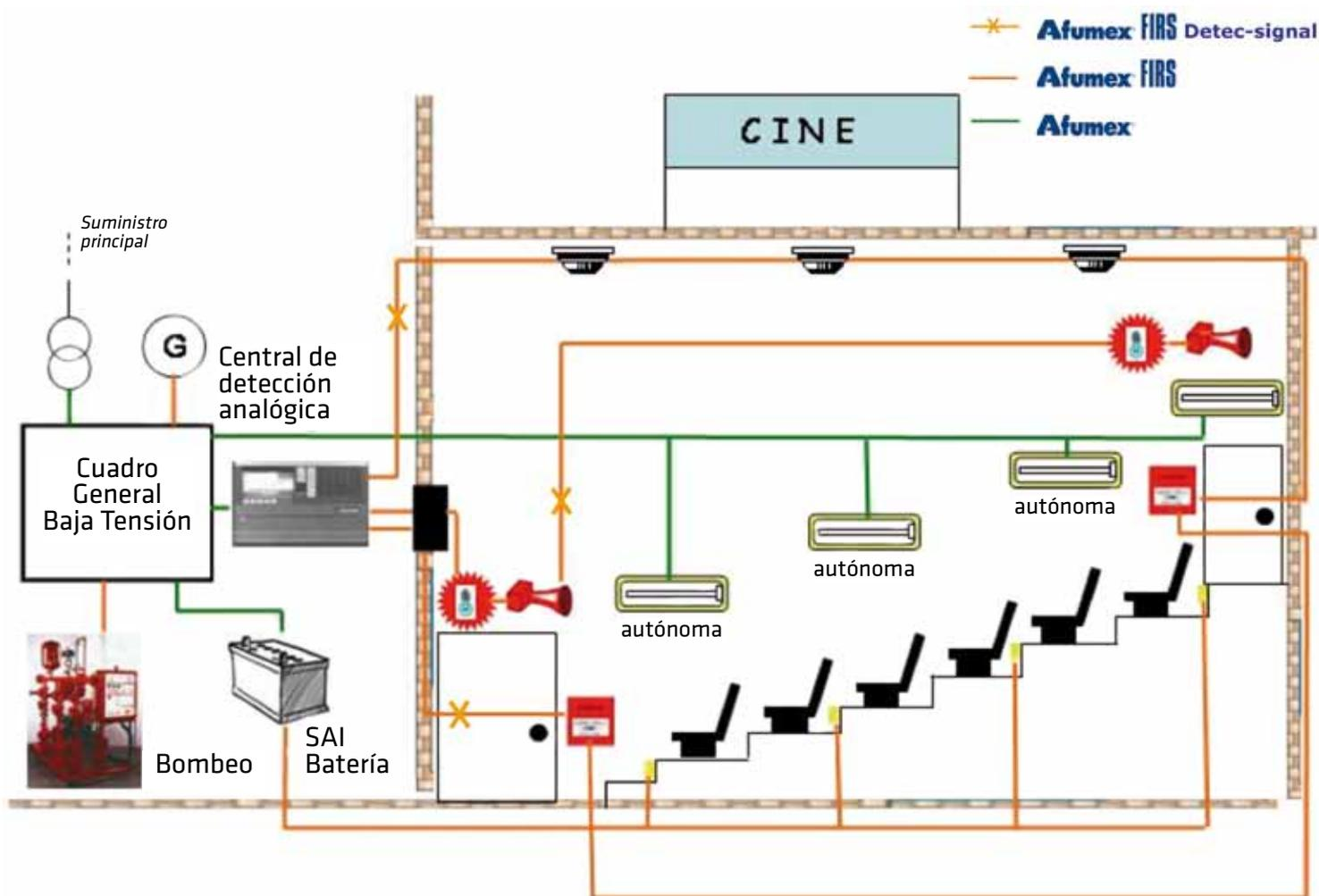
Para el caso de instalaciones contra incendios con central de detección analógica podemos ver que tanto el lazo como las alarmas están alimentados con Afumex Firs Detec-Signal, (AS+). El esquema representado ilustra una instalación posible en un cine.
