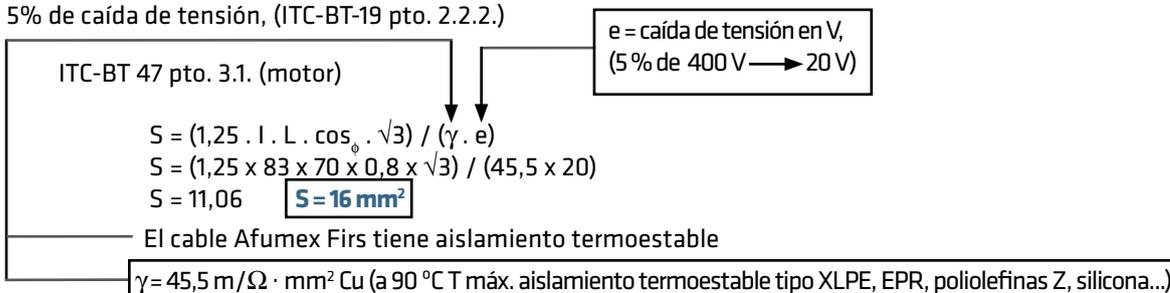
**Nota importante:**  $\gamma = 58 \text{ Cu}$  (a 20 °C),  $\gamma = 48,5 \text{ Cu}$  (a 70 °C T máx. para casos de aislamiento termoplástico tipo PVC o poliolefinas Z1).
