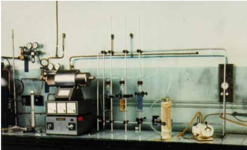
Con estos dos test similares se demuestra que el cable ensayado es libre de halógenos (no emite HCl ni otros compuestos halogenados en su combustión) y los gases emitidos son de nula corrosividad con objeto de proteger a las personas y los bienes en caso de incendio.
