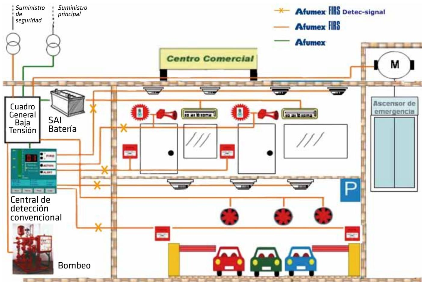
El esquema representado ilustra una instalación posible en un centro comercial con central de detección de incendios convencional. Todos los circuitos que parten de la central están representados con cable Afumex Firs Detec-Signal, (AS+) (color oscuro con aspa).
