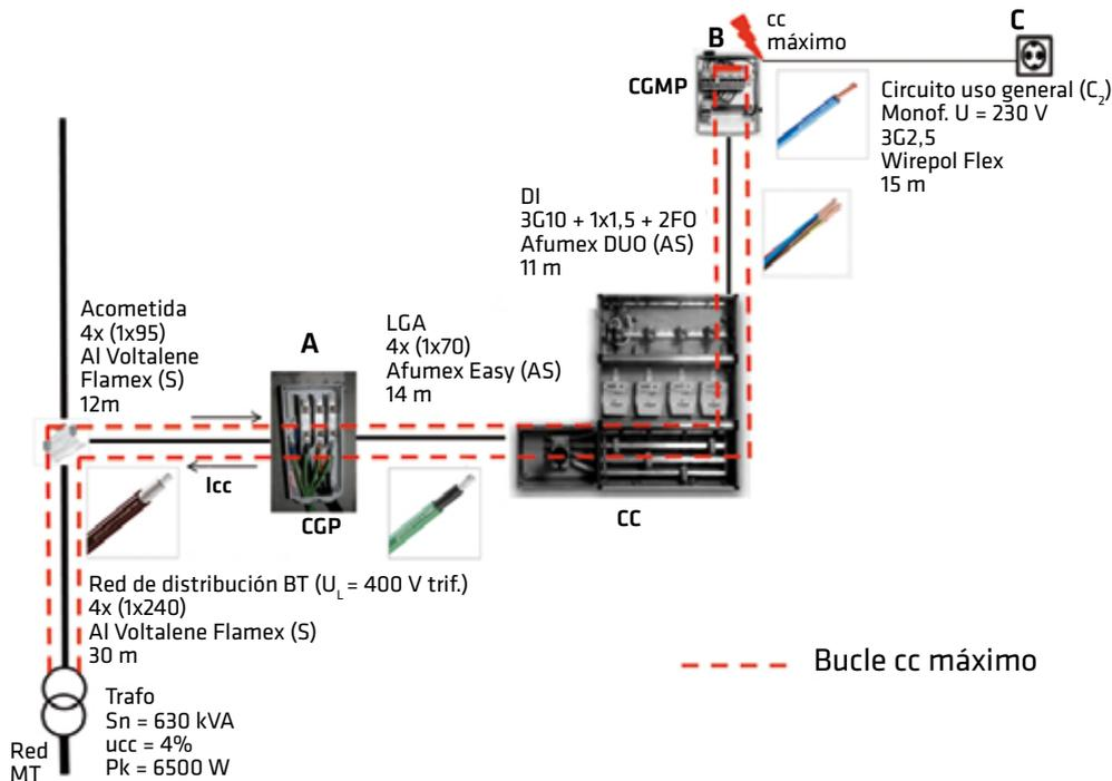
Se toma el defecto fase-neutro como el más desfavorable y se considera despreciable la reactancia inductiva de los cables. La resistencia de los conductores para el cálculo será a  $20 \text{ }^\circ\text{C}$  (menor que a mayores temperaturas de funcionamiento pues como sabemos todo conductor se calienta por la circulación de la corriente y su resistencia aumenta). De esta forma, al emplear valores mínimos de impedancia en las líneas, siempre nos resultará el cortocircuito más elevado posible.
