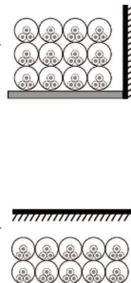
En este caso en una sola tabla tenemos el coeficiente apropiado en función del número de circuitos bajo tubo por capa y el número de capas. Hemos eliminado los coeficientes de corrección a aplicar en el caso de capa única porque lo tenemos en la citada tabla Tabla A.52-3 (UNE 20460-5-523: nov '04).
