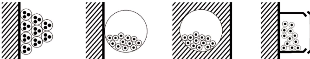
Con esta explicación ya resulta más fácil poder tener valores para diferentes agrupamientos (mazos de cables) como los que se dan típicamente en el interior de los cuadros eléctricos o en agrupamientos de circuitos bajo canal protectora.
