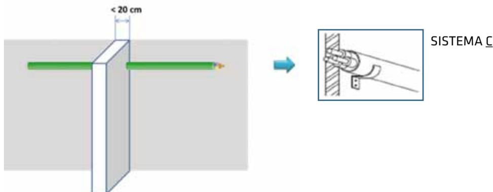
En ocasiones no cambia el sistema de instalación pero la disipación térmica se ve afectada por una agrupación de circuitos que no está presente todo el recorrido de la canalización eléctrica. En tal caso, el punto 2.2.3 de la GUÍA-BT-19\* del REBT nos dice textualmente:
