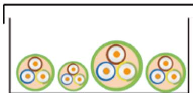
En canales protectoras lo idóneo es instalar cables multipolares para no confundir conductores de diferentes circuitos.
