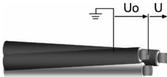
En un sistema de corriente continua, la tensión del sistema no debe sobrepasar 1,5 veces la tensión asignada del cable.
