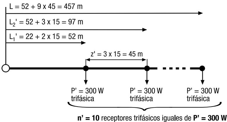
Aplicamos la fórmula para redes trifásicas, teniendo en cuenta el coeficiente 1,8, en ausencia de datos más precisos del fabricante, por el que debemos multiplicar la potencia de cada receptor por ser lámparas de descarga (ITC-BT 44, pto. 3.1, 4º párrafo):
