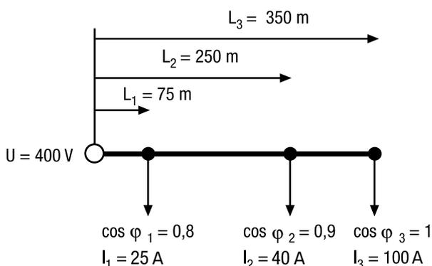
$$S = \frac{\sqrt{3} \times (75 \times 25 \times 0,8 + 250 \times 40 \times 0,9 + 350 \times 100 \times 1)}{44 \times (20 - 1,1732 \times 10^{-3} \times 0,08 \times (75 \times 25 \times 0,6 + 250 \times 40 \times 0,436 + 350 \times 100 \times 0))}$$
