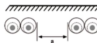
\* **NOTA:** los valores indicados en estas tablas 52-E2 y 52-E3 se aplican para una profundidad de 0,7 m y una resistividad térmica del terreno de 2,5 K.m/W.
