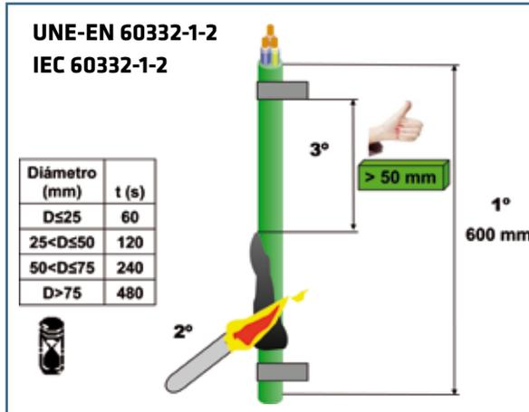
El ensayo de no propagación de la llama (UNE-EN 60332-1-2 e IEC 60332-1-2) consiste en comprobar la ignifugación de una muestra única de cable en posición vertical. En función del diámetro exterior del cable se aplica la llama entre 1 y 8 minutos. El ensayo se considera superado si el cable no es afectado por el fuego más allá de los 5 últimos cm. Además se limita también la propagación hacia abajo del fuego.
